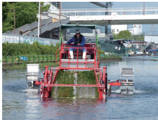
水生植物の刈取り、回収を行います。 メッシュ状のコンベアにより、水気を切りながら、 水草を回収します。
