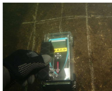
水中鉄筋探査
